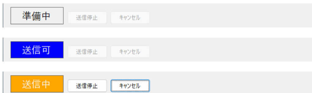
図 5-6:試験用電文の送信状態を示す表示。上から、準備中、送信可、送信中。
