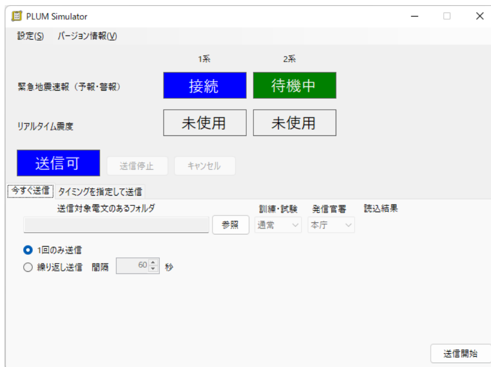
図 4-2: 状態表示・操作画面のテスト対象機器との接続状態表示 (PLUM Simulator が TCP サーバとなる場合)
