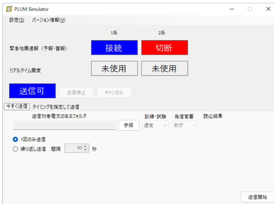
図 4-3: 状態表示・操作画面でのテスト対象機器との接続状態表示 (PLUM Simulator が TCP クライアントとなる場合)
